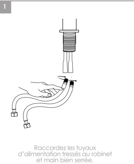
Raccordez les tuyaux d'alimentation tressés au robinet et main bien serrée.
