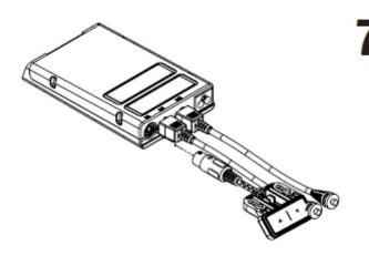
CONNECT THE HANDSWITCH (HS) CABLE TO THE CONTROL BOX
