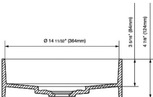
DRAIN COVER TOP VIEW / VISTA SUPERIOR DE LA TAPA DE DRENAGE / VUE DE HAUT DU COUVERCLE DE DRAIN
